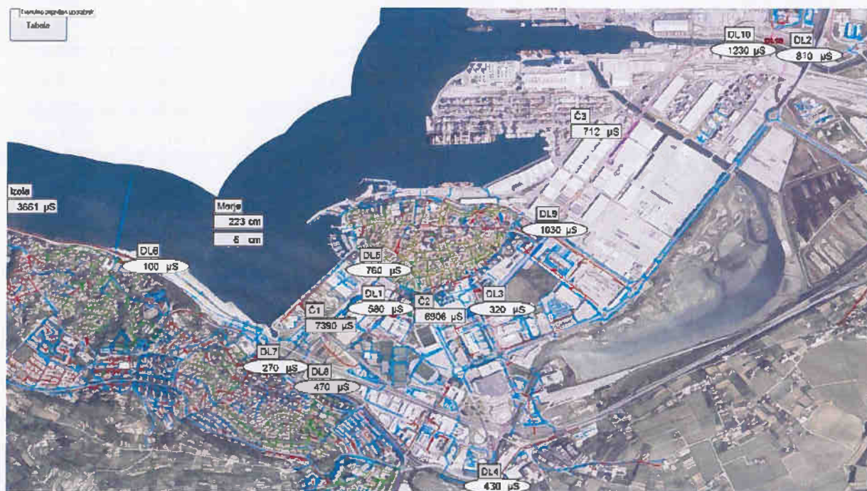
Slika 2: Sistem meritev prevodnosti (slanosti) – datalogerji
